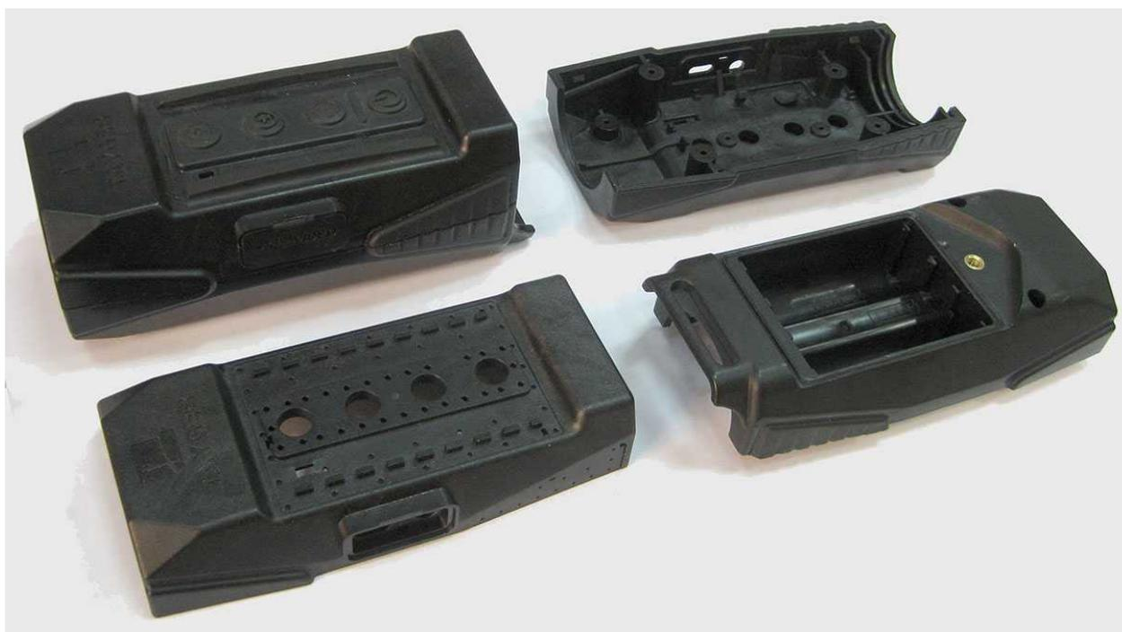
Технические особенности: Двухкомпонентное литье - изготавливаются две пресс-формы (см рисунок слева) и изделие "льется" в два этапа:
