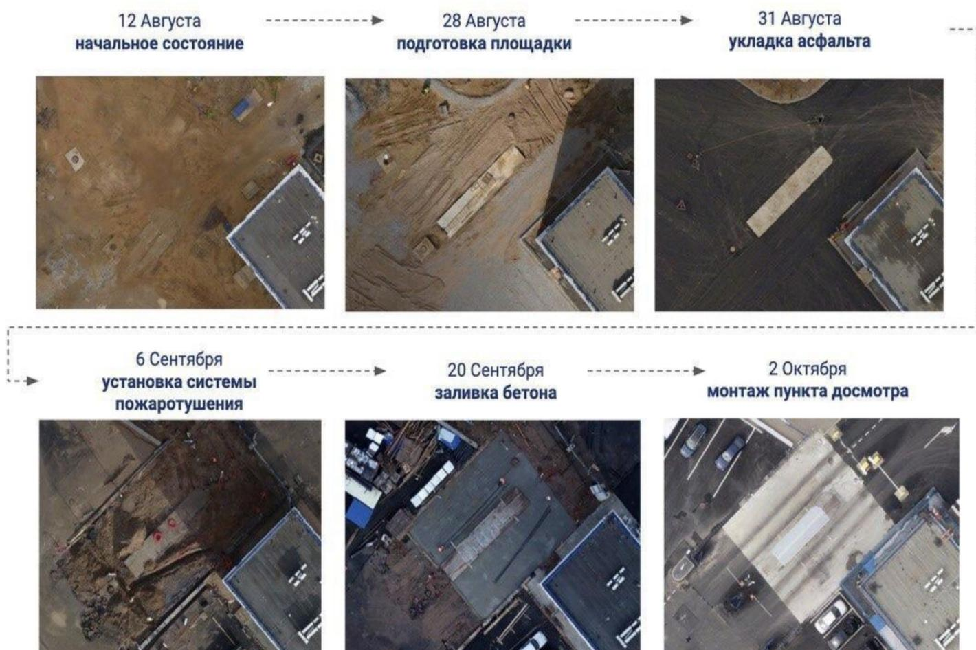
При строительстве пункта досмотра подрядчик не установил систему пожаротушения. **Мониторинг хода работ в платформе SKYEER позволили выявить ошибку.**
