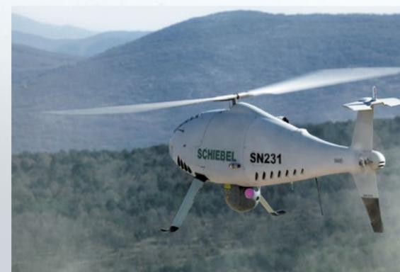
S-100 отлично работает в условиях сложной местности, где отсутствуют аэродромы или взлетно-посадочные полосы. Кроме того, поскольку аппарат снабжен системой ВВП, ему не нужна подготовленная площадка или дополнительное оборудование для взлета и приземления.
