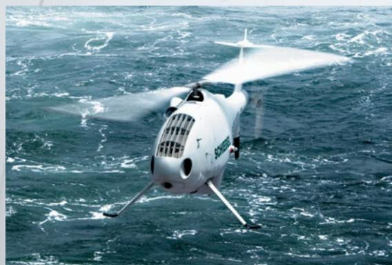
Он полностью защищен от коррозии благодаря широкому применению материалов из углеродного волокна, нержавеющей стали, титана, анодирования и особых покрытий.
